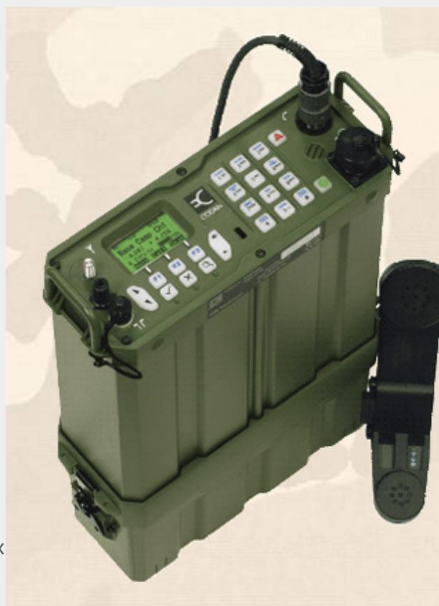
производила, соответствующая самым жестким требованиям стандартов, включая MIL-STD-810F. Трансивер и батарея полностью водонепроницаемые и могут быть полностью погружены в воду.
