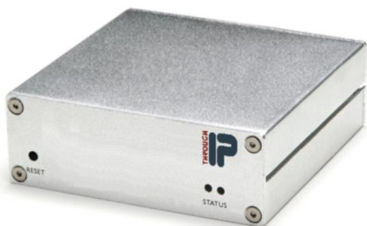
Комплект состоит из включенного AT IP1 в сеть Ethernet и подключенной к трубке трансивера, динамика через поставляемые кабели и подсоединенного источника постоянного тока питания 12 В. Затем требуется всего несколько простых шагов для нахождения или установки IP адреса аппарата. Далее конфигурация устанавливается через веб браузер, подсоединенный к сети.
