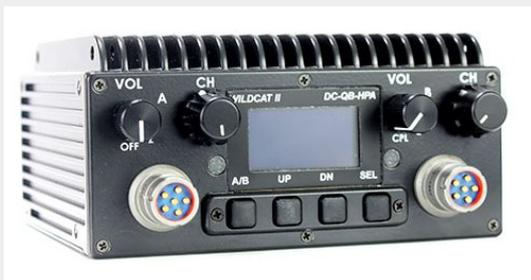
TrellisWare TW-130 WildCat II разработан для тактических систем связи, требующих высокого уровня мощности и расширенной зоны покрытия. Функция двойного канала WildCat II, вместе со встроенным усилителем мощности, позволяет организовать канал дальней связи в качестве транзитного соединения и использовать устройство в качестве шлюза для взаимного объединения нескольких TSM™ сетей.
