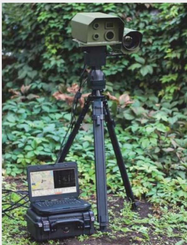
Комплекс представляет собой многофункциональное оптоэлектронное устройство, предназначенное для круглосуточного видеоконтроля местности, поиска целей и автоматического обнаружения скрытых устройств оптического прицеливания и слежения, определения их координат и дальности в условиях сложного рельефа местности и городских сооружений.
