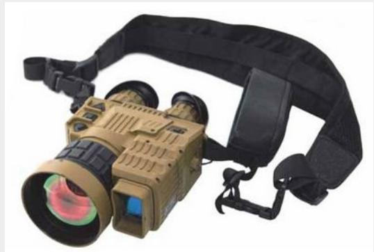
Тепловизионный бинокль TGX-8/75 предназначен для наблюдения и контроля за различными областями в условиях ограниченной видимости: слабое освещение, задымление, туман, объекты скрыты растительностью или сливаются с подстилающим ландшафтом. Отличительная черта этого бинокля - встроенный лазерный дальномер диапазона 1550 нм, который позволяет оперативно определять расстояние и дальность объектов.
