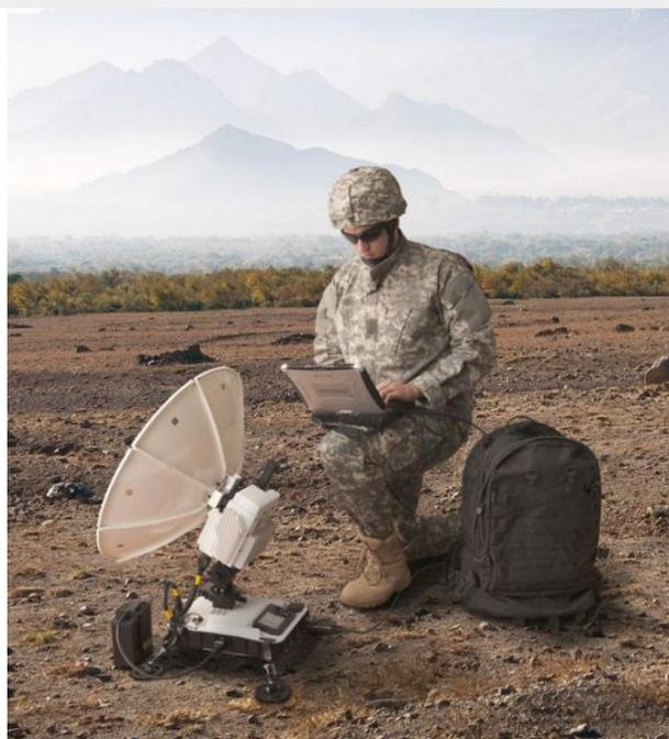
Panther™ 0.6 является переносным терминалом спутниковой связи для высокоскоростной передачи данных в трёх частотных диапазонах: X-, Ku- и Ka-. Чрезвычайно прочный и лёгкий, VSAT терминал Panther™ позволяет создавать интернет и VPN соединение и передавать видеосигнал на значительно более высоких скоростях. Этот универсальный VSAT комплект также обеспечивает простую настройку, плавную и точную регулировку и возможность управления с помощью встроенного графического интерфейса пользователя (ГИП).
