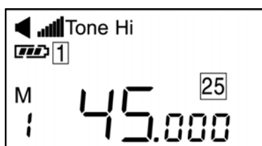
Канал памяти приёмный режим - канал памяти 1
