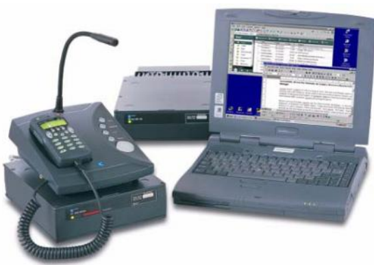
Modem de données HF 3012, Console de bureau du NGT, Unité RF NGT et ordinateur
