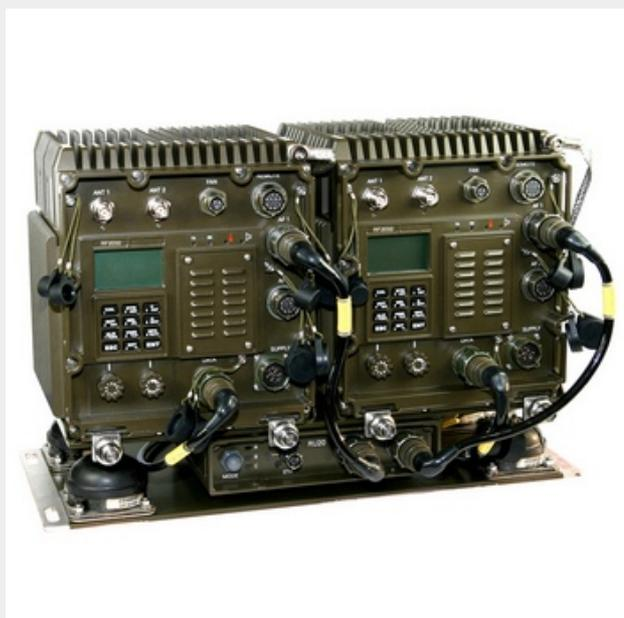
Репитер AT AR20 представляет собой устройство автоматической ретрансляции в режиме фиксированной частоты в соответствии с требованиями стандарта STANAG 4204, а также в режиме ППРЧ используя тип модуляции HW20. Репитер предназначен для совместного использования в системах связи с трансиверами AT RF23, AT RF20, AT RF2050.
